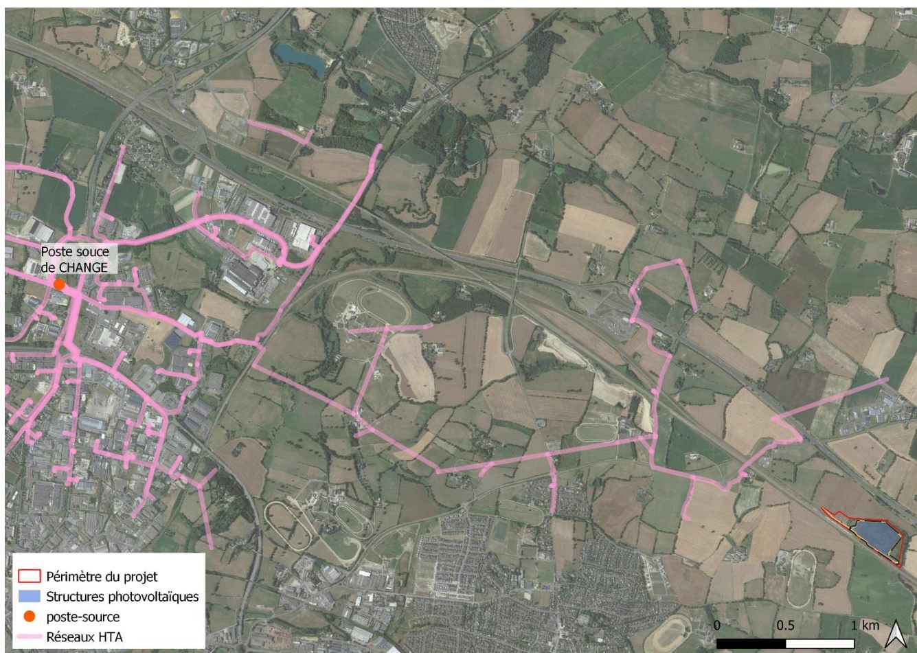
Carte 3 : localisation du réseau HTA, en départ direct depuis le poste source
